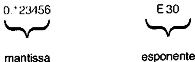
La mantissa viene memorizzata in tre byte dove uno dei bit è usato dal segno. Si ottengono così le sette cifre decimali significative, a precisione singola. L'esponente occupa un byte, di cui un bit per il segno, e può arrivare fino a 127. Il limite di rappresentazione di un intero positivo è dunque di  $2^{127}$  e di circa  $10^{38}$ .
