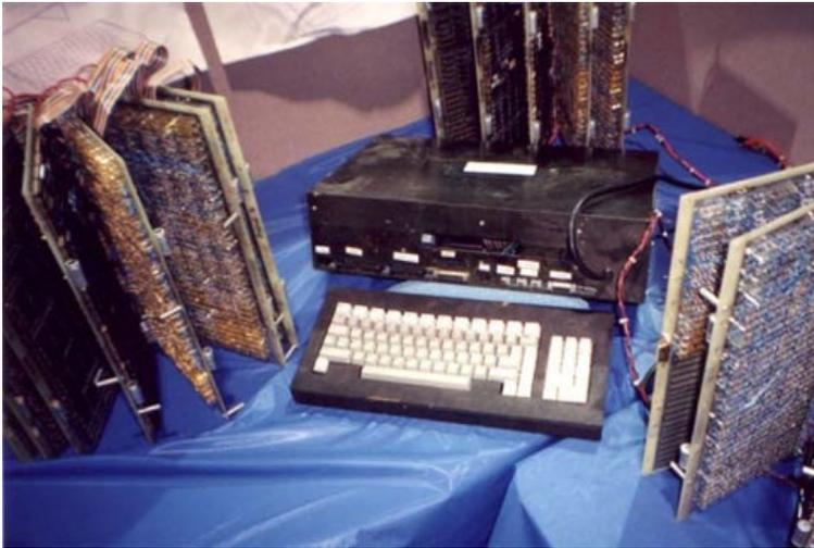
*Fig. 43: il prototipo di Amiga*
